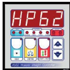
Damızlık kümeslerinde elektronik kantar ile birlikte yemin hassas bir şekilde tariplip kümes içi yem depolarına transfer edilmesini kontrol eder.
