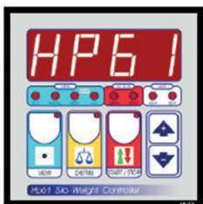
Silodaki yem miktarının görüntülenmesini sağlar ve kümes içi yem depolarına yem naklini gerçekleştirir.
